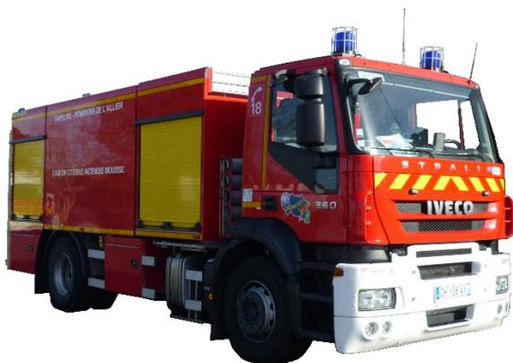
Les CCIM sont utilisés en alimentation et disposent de bâches souples permettant la réalimentation des engins de lutte. Toutefois, ses capacités limitées (7000l) sont un réel inconvénient au regard des capacités d'un CCFS
