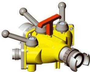
Il s'agit d'une division mixte 45/45-5X25 avec un clapet anti-retour. Elle maintient en eau l'établissement de grande longueur sur les pentes positives en cas de rupture d'un tuyau en évitant la perte de la colonne d'eau se trouvant en amont de ce clapet, mais permet aussi un gain de temps appréciable lors du refoulement (une minute pour cent mètres environ).
