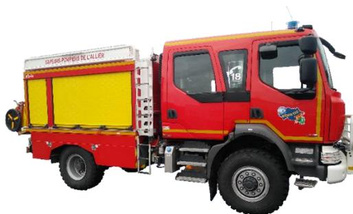
Ce sont des véhicules qui sont mixtes. Ils offrent les capacités hydrauliques du FPT ainsi que la possibilité de s'engager sur un terrain peu accidenté. Ils sont classés en catégorie 2.
