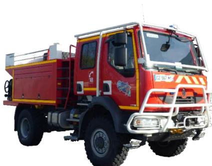
Le CCFM est le véhicule par « excellence » de la lutte contre les feux de forêts. C'est le plus courant du fait de ces capacités opérationnelles, notamment en matière de franchissement. En effet, ce véhicule est classé en catégorie 3. De plus, c'est le véhicule de base de la composition du groupe d'intervention feux de forêts.
