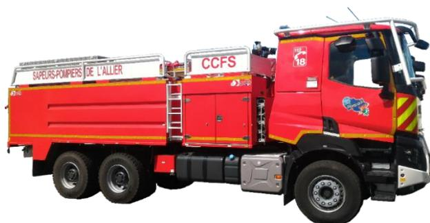
Les véhicules lourds sont engagés dans la lutte contre les feux de forêts en primo intervenant, en appui des CCF M grâce à leurs capacités hydrauliques supérieures liées à la capacité en eau, la pompe et parfois à la présence d'un canon. En effet, ils sont intégrés dans les GIFF ou GIFFEN à raison d'un CCFS par groupe.
