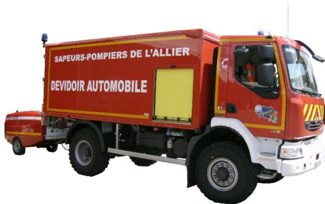
Le CDHR et sa MPR permettent de disposer d'une alimentation pérenne même éloignée d'un point d'eau naturel car il est équipé de 3 km de tuyaux de 100 mm.
